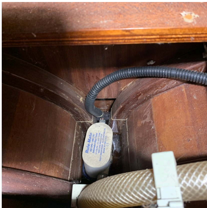
Abb.#30: Automatische Bilgenpumpe
