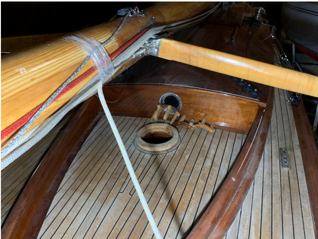
Abb.#17: Decksdurchbruch für Mast
