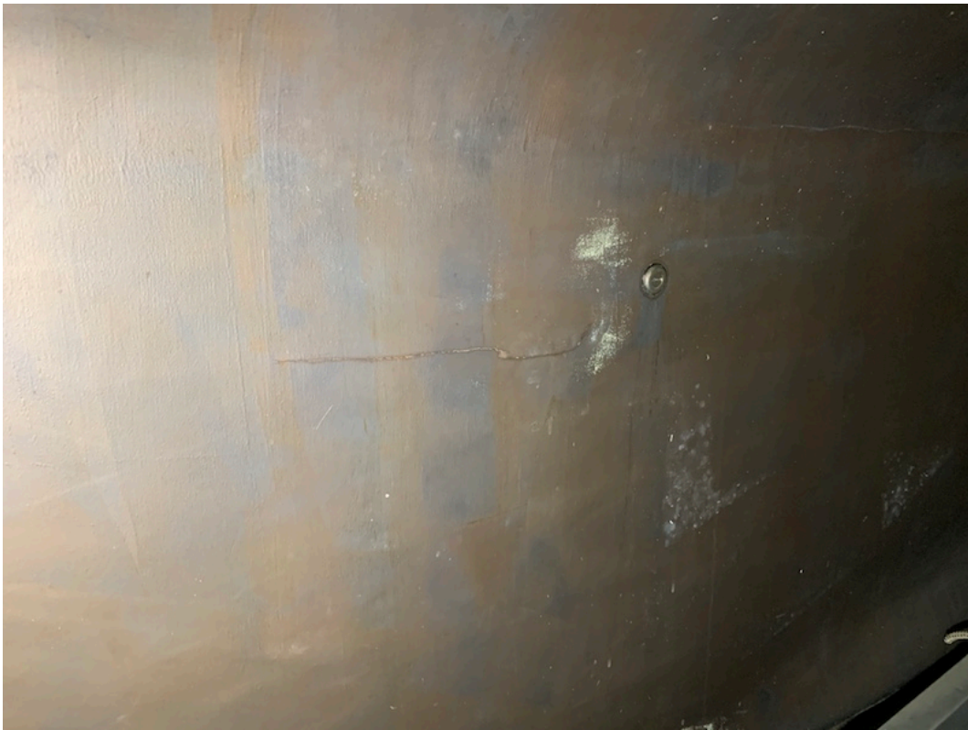
Abb.#8: Kiel, steuerbord Seite, Riss im Antifouling
