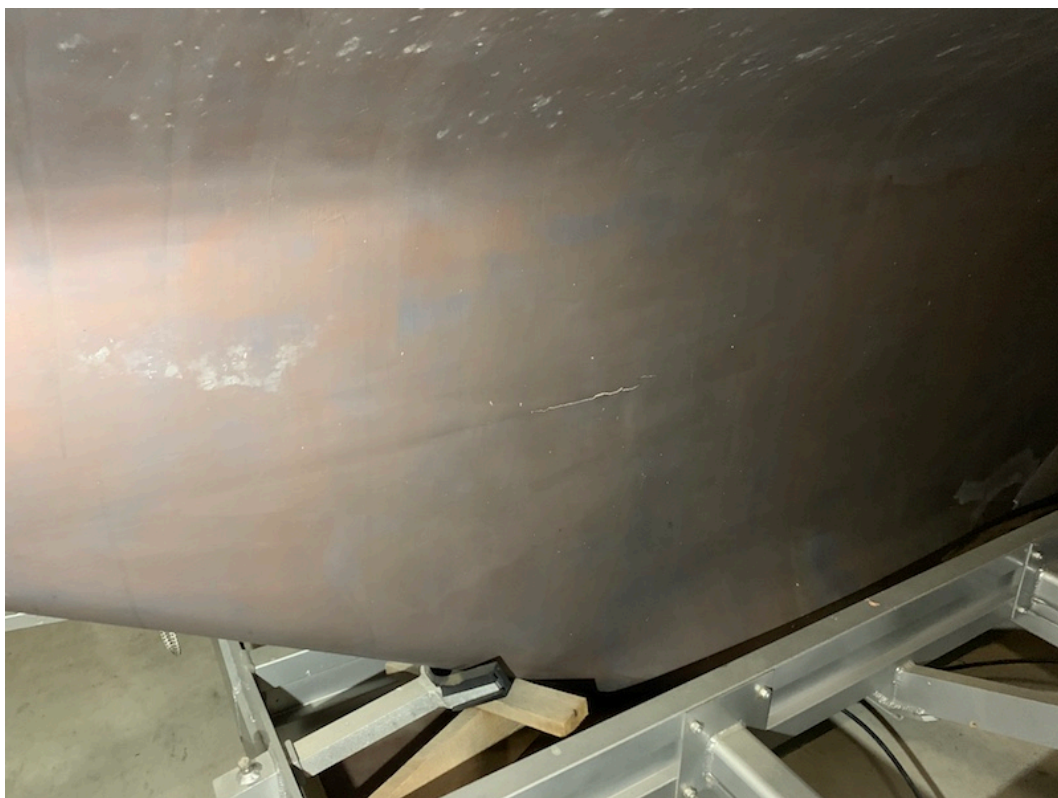
Abb.#10: Kiel backbord Seite, Riss im Übergang Kiel zu Totholz
