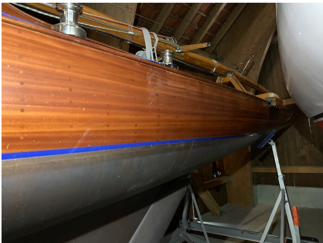
Abb.#5: Außenhaut mit eichten Kratzern im Lack, Fenderabriebspuren
