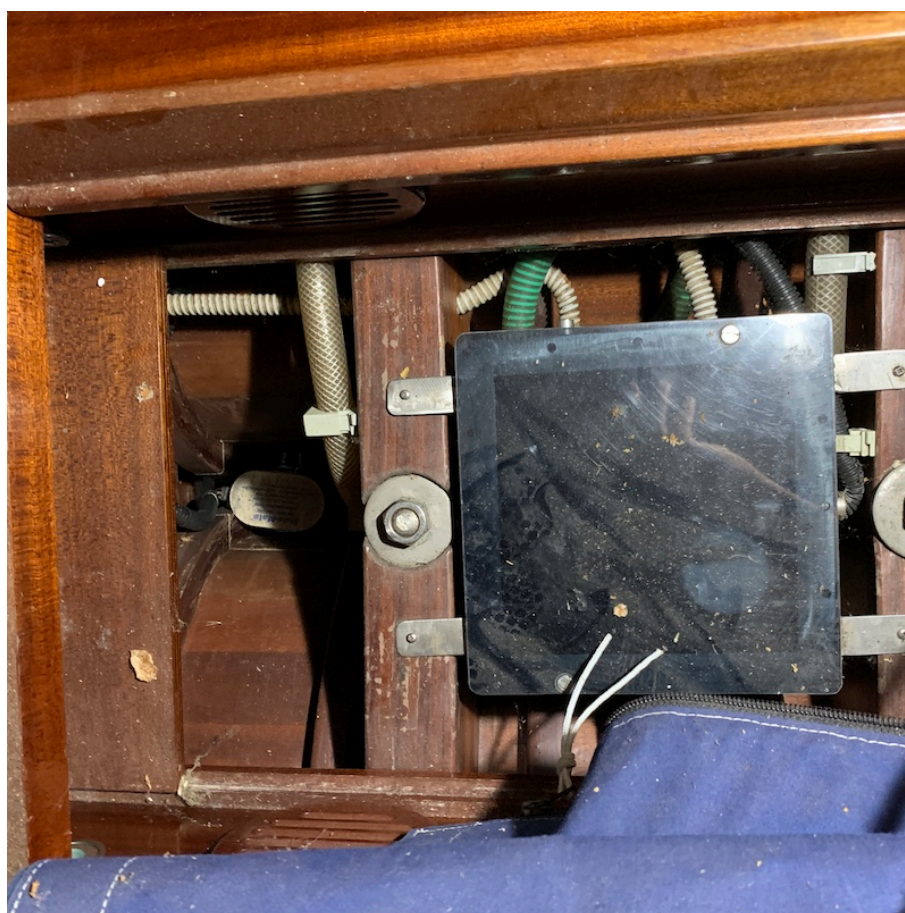
Abb.#29: Bilge mit kleinem Grauwassertank
